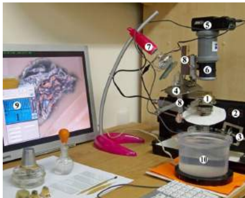
Рис. 2.2. Програмно-апаратний комплекс для 3D-реконструювання мікроскопічних структур за серією мікротомних зрізів:
