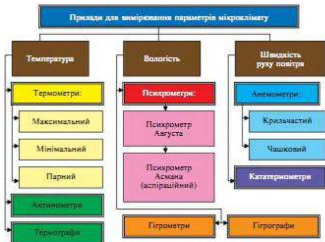
Рис. 12. Класифікація приладів для вимірювання параметрів мікроклімату виробничих приміщень
