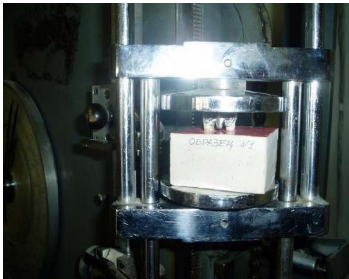
Рис. 2.8 Лабораторне дослідження фантомних МПАФ.
