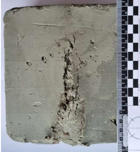
Рис. 3.24.а. Верхня частина пластилінового блока з викришуванням
