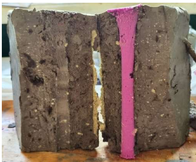
Рис. 2.3. Процес відшарування балістичної глини від зліпку ранового каналу (вертикальна проекція)
