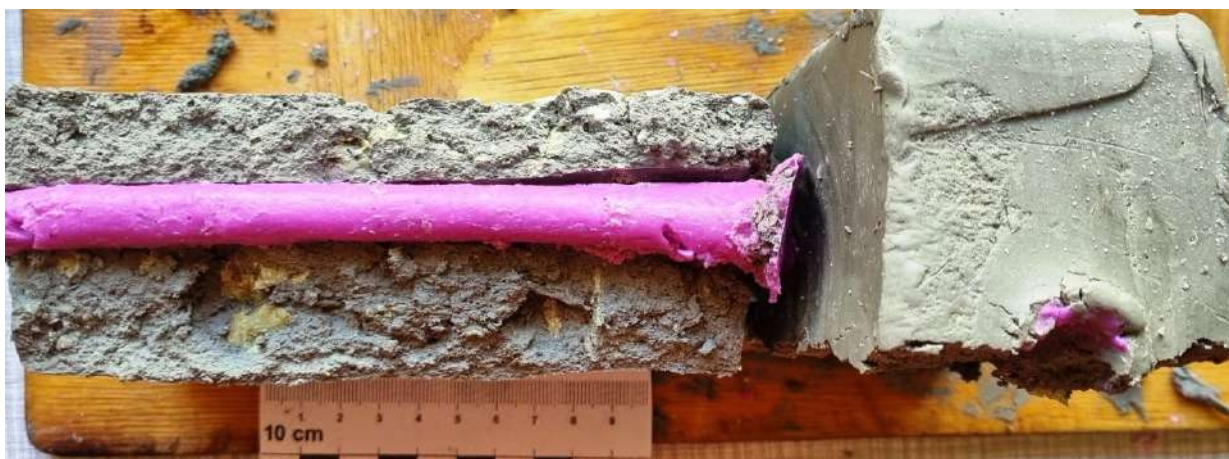
Рис. 2.2. Процес відшарування балістичної глини від зліпку ранового каналу (горизонтальна проекція)
