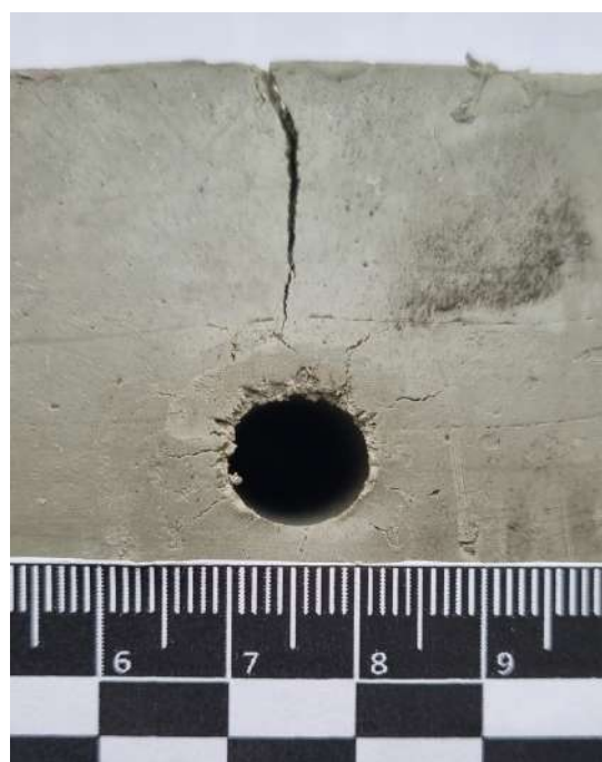
Рис. 3.23.б. Вхідна частина каналу (з розтріскуванням)
