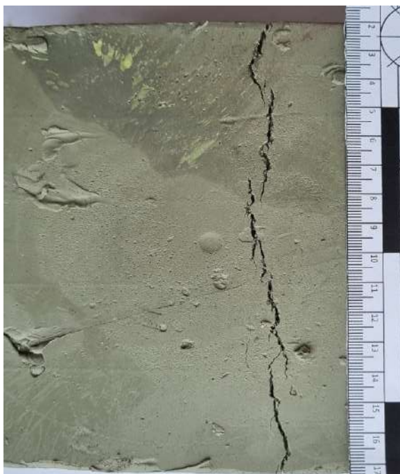
Рис. 3.23.а. Верхня частина ранового пластилінового блока з повздовжною тріщиною
