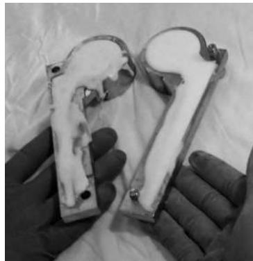
Рис. 3. Відкрита прес-форма в процесі заповнення напіврідким кістковим цементом
