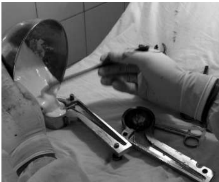
Рис. 3. Відкрита прес-форма в процесі заповнення напіврідким кістковим цементом
