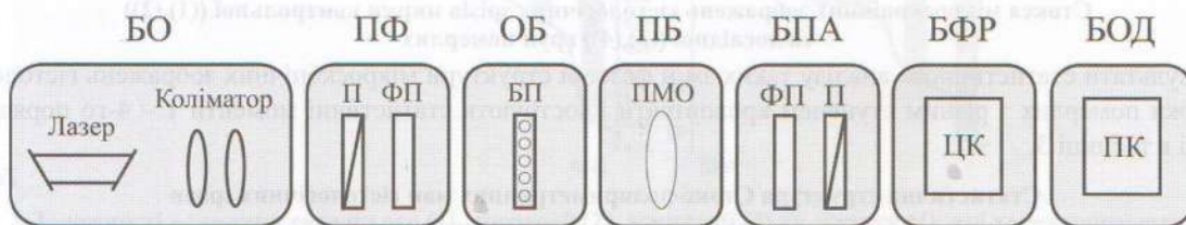
Рис. 1. Функціональна блок-схема багатопараметричної поляризаційної мікроскопії.
