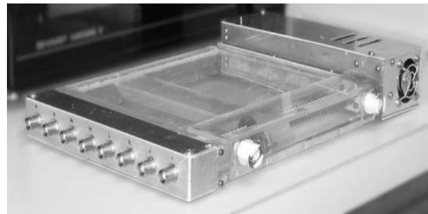
Рис. 1. Ультразвуковий аплікатор з глибинно-контрольованою депозицією тепла при поверхневій гіпертермії. Аплікатор містить 16 ультразвукових елементів (з робочими частотами 1.9 і 4.9 MHz), що дозволяє створювати поверхневі температурні поля розміром 2 см x 2 см. Вода, що циркулює в аплікаторі, дозволяє охолоджувати як сам аплікатор так і поверхню шкіри пацієнта [9].
