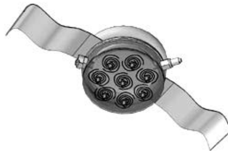
Рис.5. Мікрохвильовий аплікатор MA-151 для мікрохвильової абляції (видалення) ракових пухлин. Загальна область дії аплікатора 4x5 см з температурними ділянками 2.5x 2.5 см і глибиною дії до 2 см. (Фото з сайту www.bsdmc.com ).
