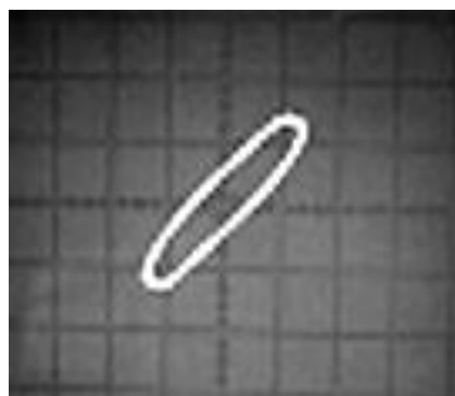
Рис. 1 – Вольт-амперна характеристика системи метал-плівка-метал
