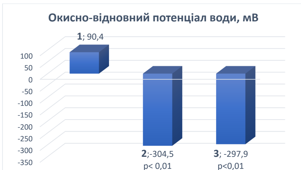
Рис. 3.1. Величина окисно-відновного потенціалу (мВ) води: 1 – звичайна водогінна вода, 2 – вода від’ємного окисно-відновного потенціалу з обробкою препаратом мікрогідрин, 3 – вода від’ємного окисно-відновного потенціалу з додатковим насиченням молекулярним воднем. p – вірогідність різниць порівняно до звичайної водогінної води (непараметричний тест Манна-Уїтні).
