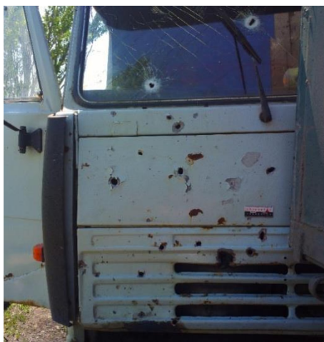
Рис. 2. Пошкодження кабіни вантажного автомобіля
